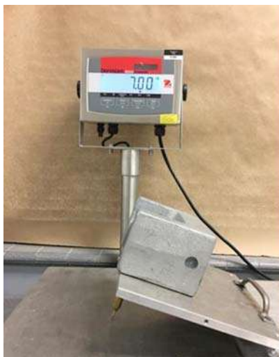
Figura 5 – Aparato para reproduzir riscos
