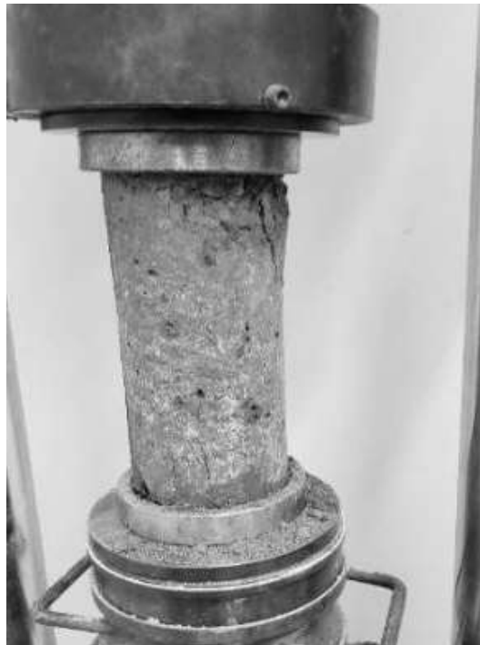
Figura 3: Ensaio de resistência à compressão realizado no concreto endurecido após 28 dias. Fonte: Do autor (2024).
