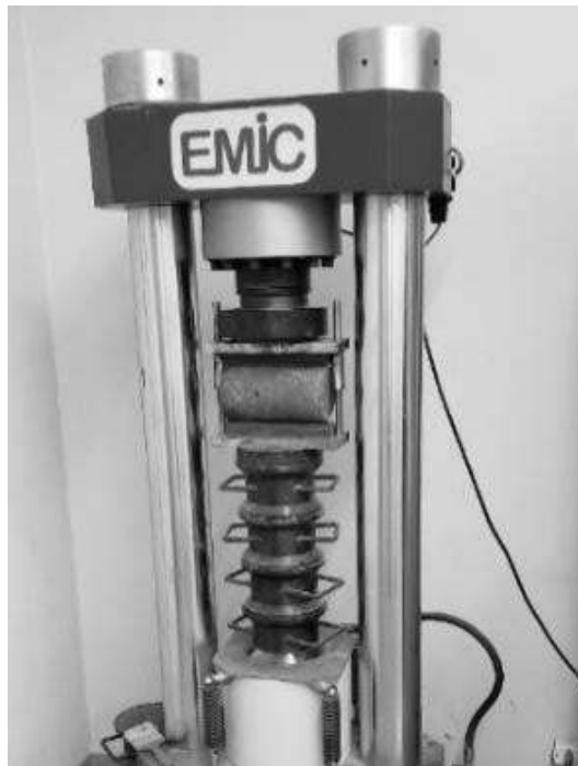
Figura 4: Ensaio de resistência à tração por compressão diametral realizado no concreto endurecido após 28 dias. Fonte: Do autor (2024).
