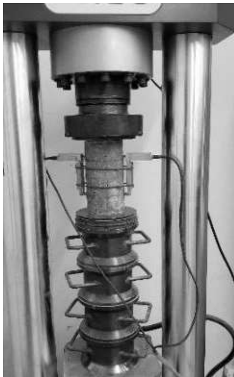
Figura 5: Ensaio de módulo de elasticidade realizado no concreto endurecido após 28 dias. Fonte: Do autor (2024).
