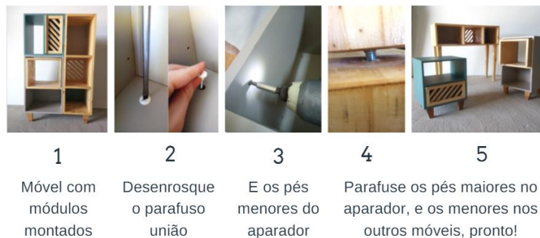
Figura 22: Etapas de desmontagem e montagem dos móveis. Fonte:Acervo pessoal.
