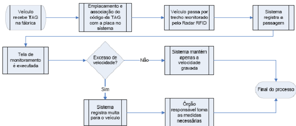
Figura 8. Fluxo de funcionamento do sistema
