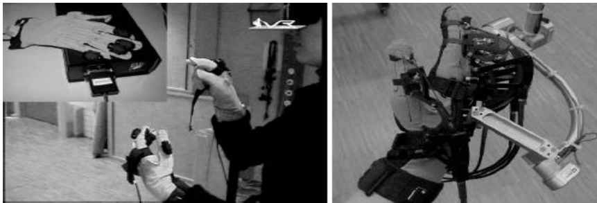
Figura 4. Luvas de dados para toque e retorno de força. Fonte: Adaptado de GUTIÉRREZ, M.; VEXO, F.; THALMAN, D. (2008, p. 149)
