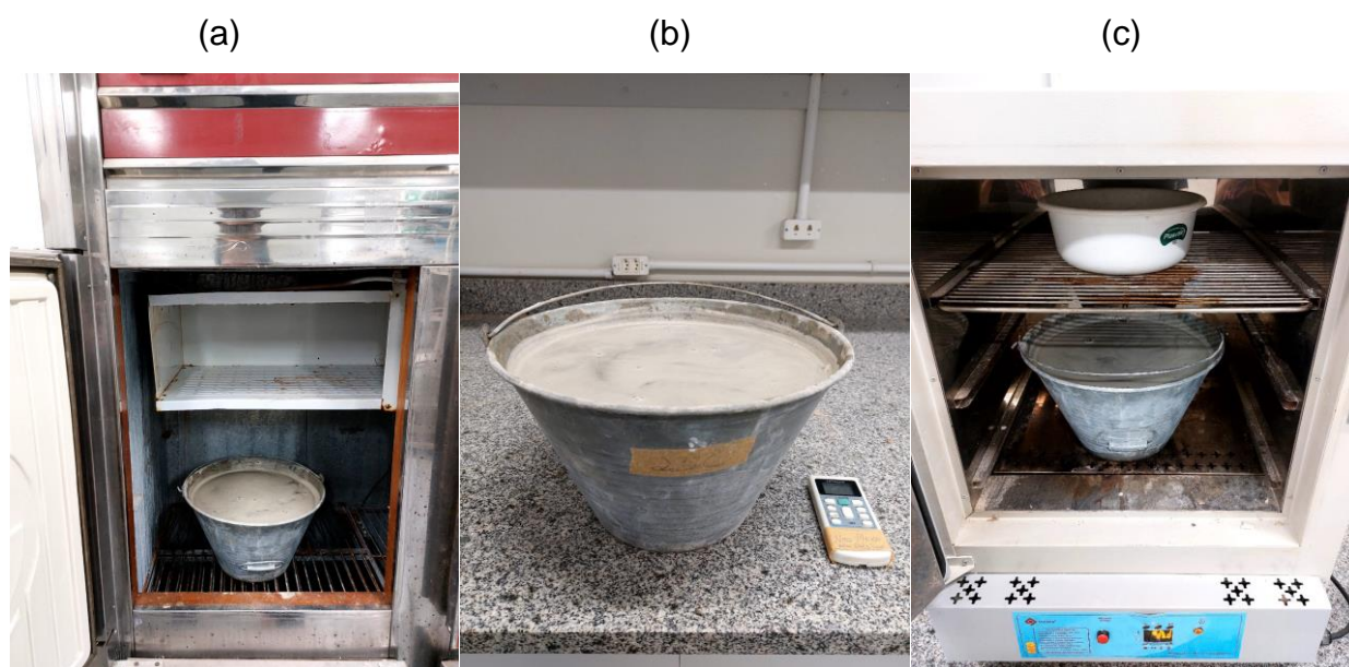
Figura 11: Condições de temperaturas durante o tempo de manuseio da argamassa estabilizada: geladeira (7 °C) (a); ar condicionado (23 °C) (b); estufa (35 °C) (c).
