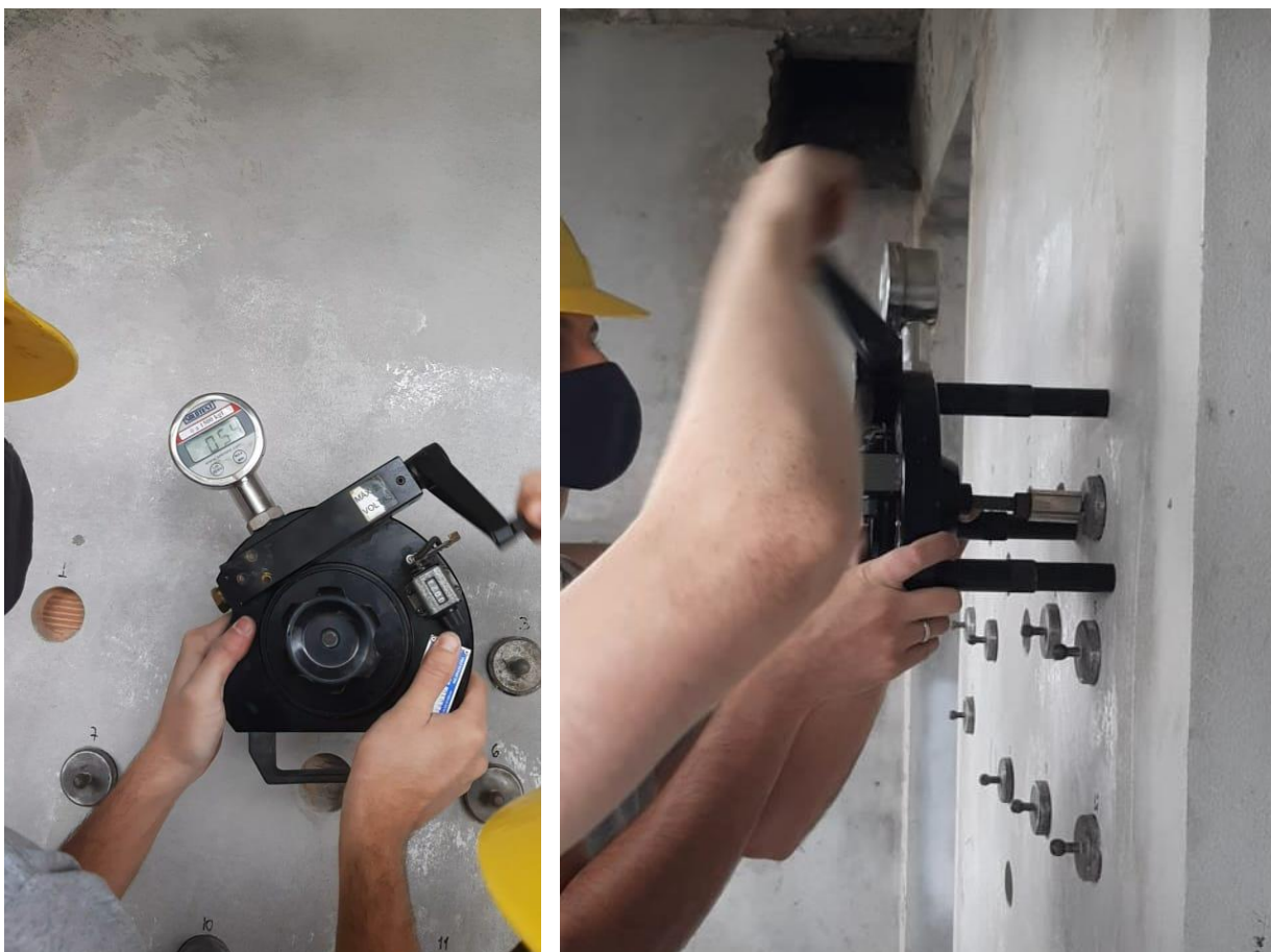
Figura 8: Ensaio de resistência potencial à tração com o equipamento "dolly".
