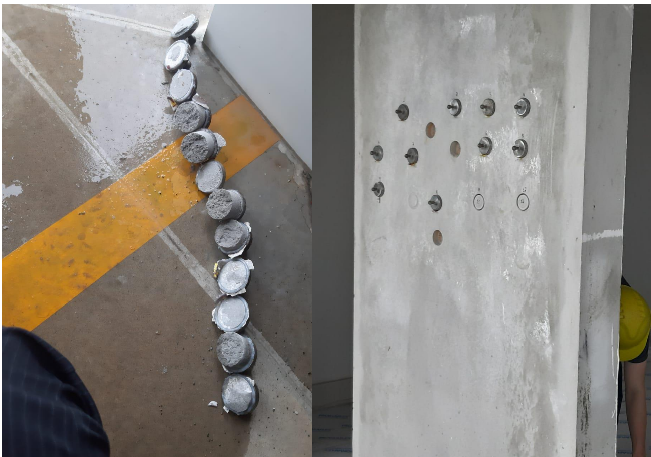
Figura 9: Imagens demonstrativas da ruptura no ensaio de resistência potencial de aderência à tração.
