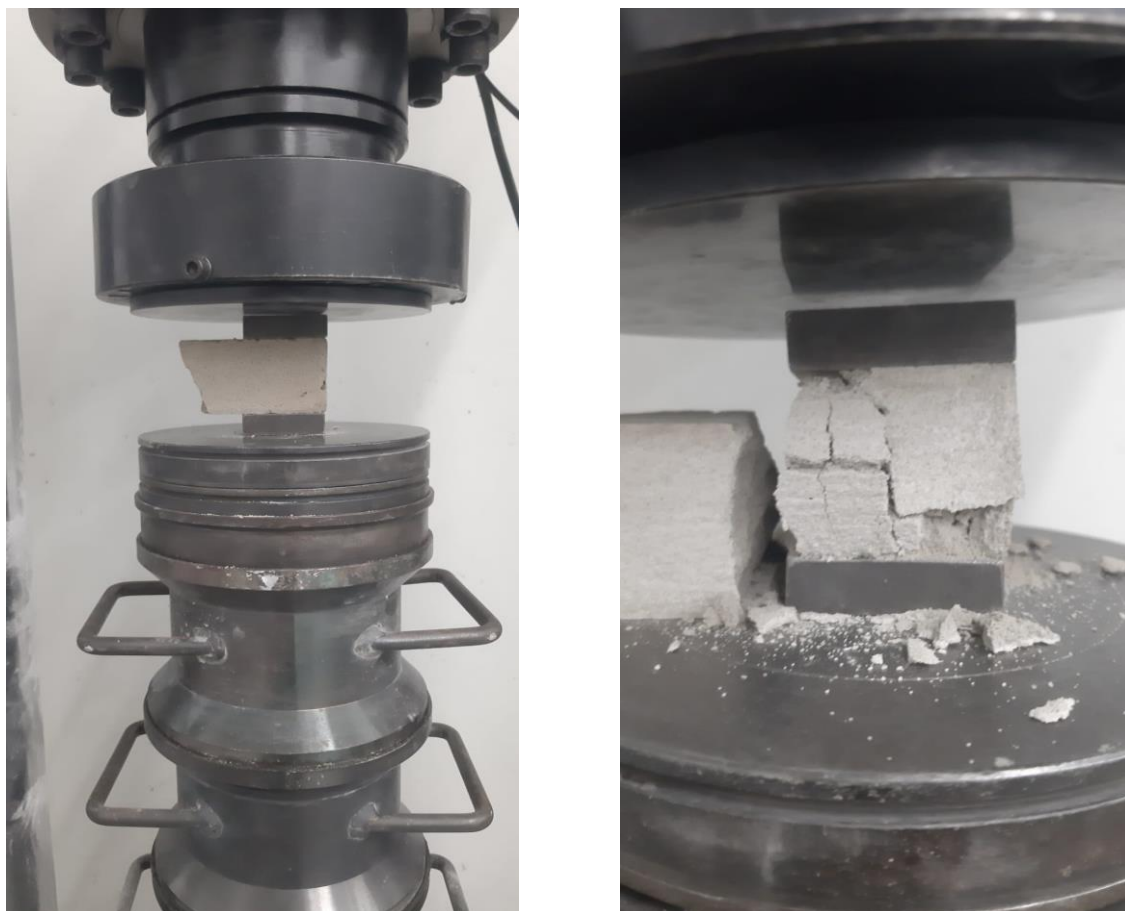
Figura 17: Imagem do ensaio de resistência mecânica à compressão realizados com parte do corpo de prova utilizado no ensaio de resistência à tração na flexão.
