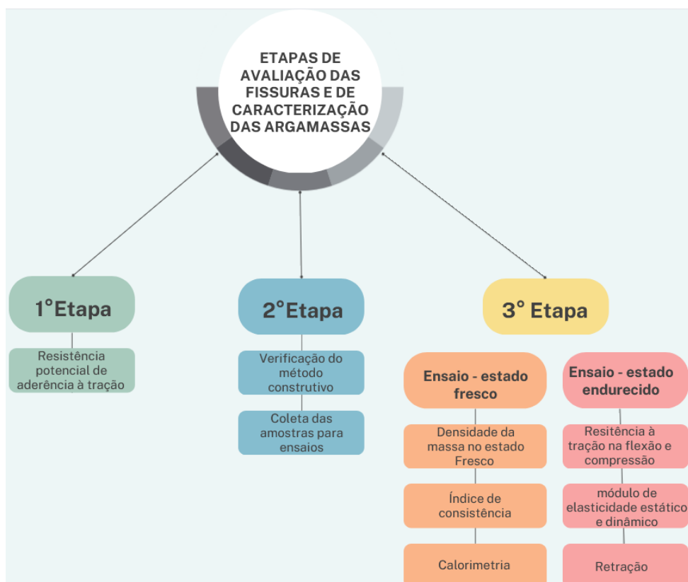
Figura 7: Representação das etapas experimentais desenvolvidas: diagnóstico das fissuras/ edificações e caracterização das argamassas estabilizadas.
