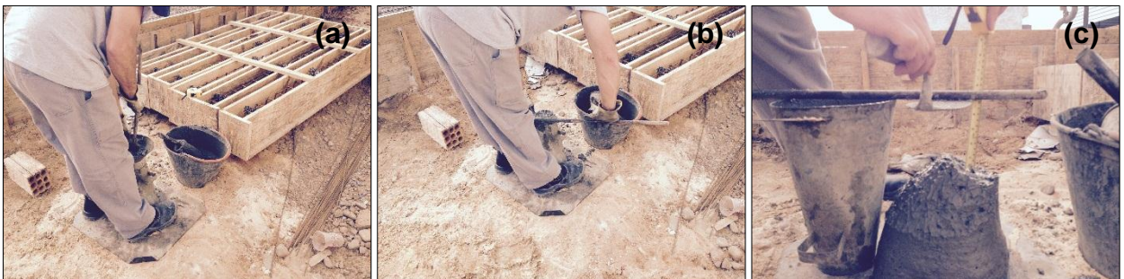
Figura 7: Slump-test - (a) abatimento; (b) arrasamento; (c) medição do cone.
