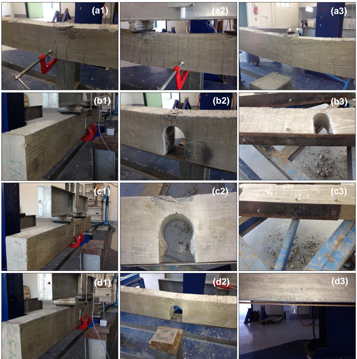
Figura 9: Fissuras - (a) Grupo Ref; (b), (c) e (d) Grupo A
