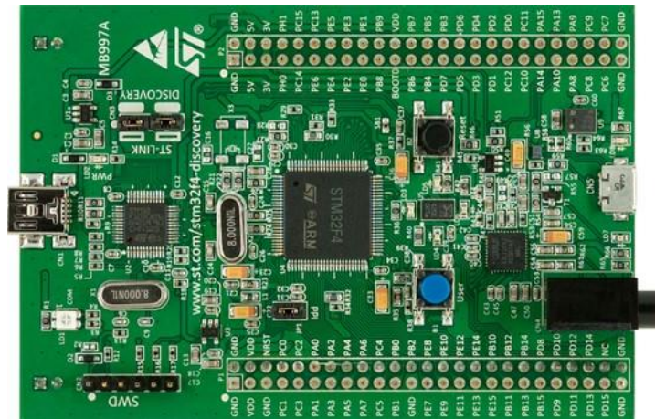
Figura 5. Placa de desenvolvimento STM32F4DISCOVERY
