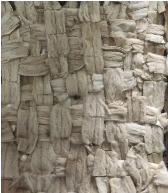
Figura 9: Tecido resultante elaborado com as bitucas de cigarro consumido.
