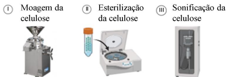
Figura 9 - Etapas para obtenção da celulose microfibrilada.
