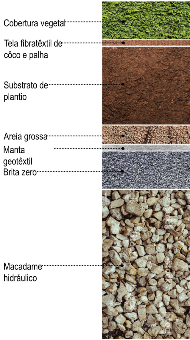
Fig. 108 – Camadas de preenchimento dos jardins de chuva. Fonte: Elaborado pela autora.
