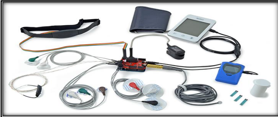
Figura 3 : plataforma de sensor e-health acoplada a placa do Arduino Uno.
