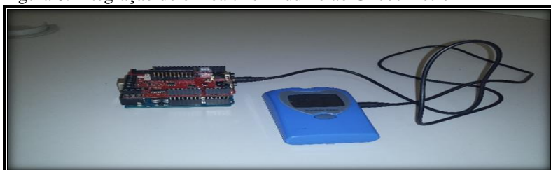
Figura 8: Integração do e-Health e Arduino ao Glicosímetro
