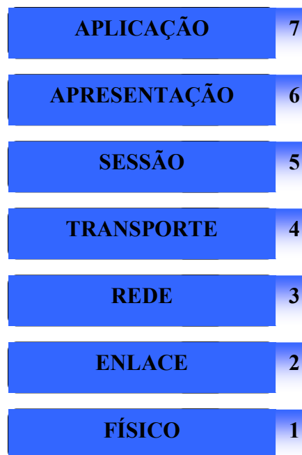
Figura 2. Camadas do modelo de referência OSI Fonte: MURHAMMER, M; GAERTNER, J. (2000)
