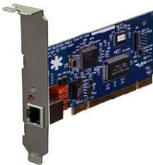
Figura 26. Placa TE110P Fonte: GONÇALVES, F. (2005)
