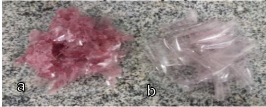
Figura 11 – (a) Borracha e (b) poliéster após processo de separação
