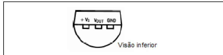
Figura 3. Componente LM35, sensor de temperatura Fonte: NATIONAL SEMICONDUCTOR (1994)
