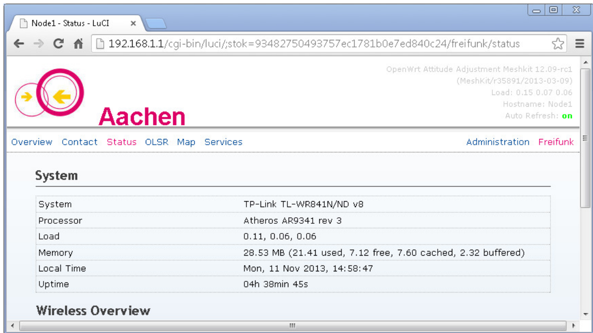
Figura 18 – Interface do firmware Freifunk customizado.
