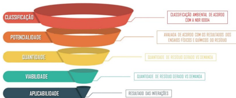
Figura 6 - Representação da sistemática CPQvA para a valorização de resíduos.
