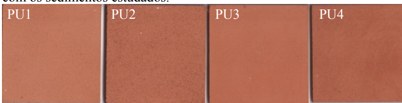
Figura 9 - Imagens dos corpos cerâmicos pós queima preparados apenas com os sedimentos estudados.
